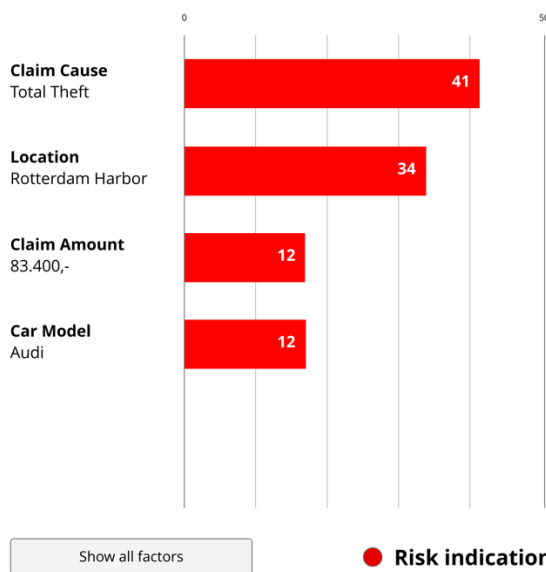
Figuur 1: Een interface voor uitleg met feature importance. De rode kleuren geven de bijdrage (in fraude-punten) van de getoonde waarde aan. De bijdrage van alle getoonde factoren is negatief (wijzen op fraude) omdat alleen de factoren die het meeste negatief bijdragen worden getoond. Bovenaan in tekst is de totale score (126) en eendoordeel (hoog risico).
